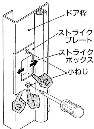
① ストライクボックスが動く程度に+ドライバーで小ねじをゆるめる。
