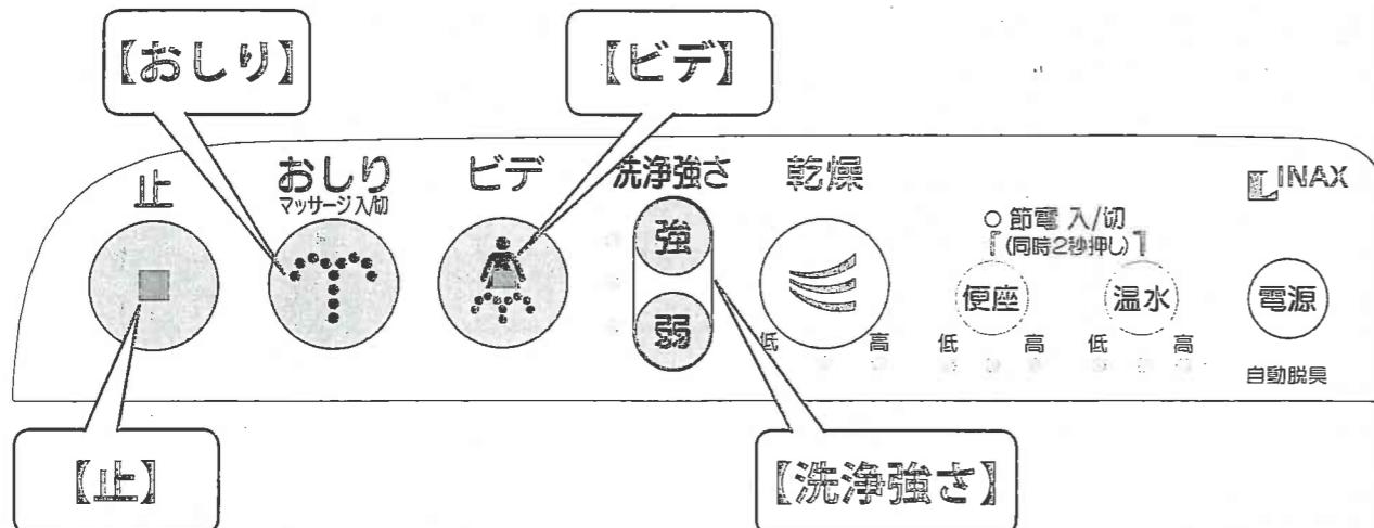
●【洗浄強さ】でシャワーの強さを調節する
